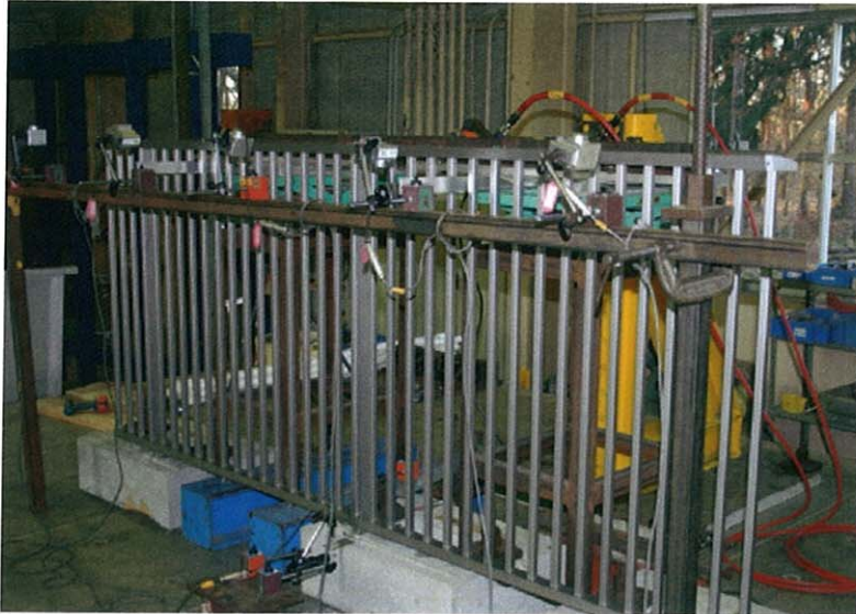
写真-4・1・4 試験実施状況 ユニットの水平荷重試験 加力状況(試験体:UK-B)
