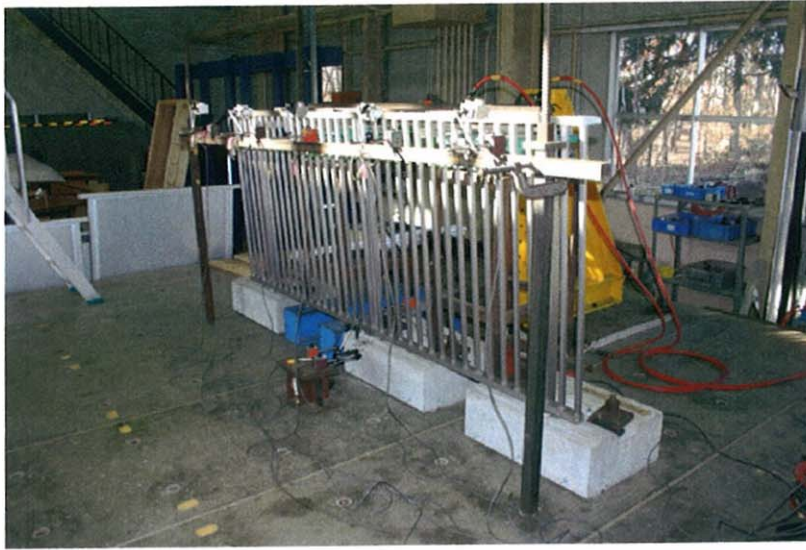
写真-4.1.1 試験実施状況 ユニットの水平荷重試験 加力状況(試験体:UK-A)
