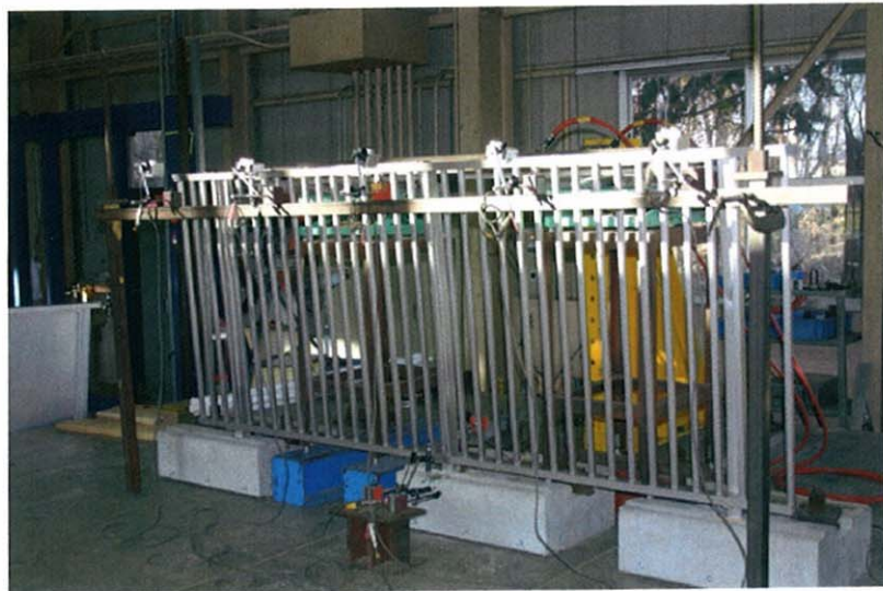
写真-4.1.2 破壊状況 ユニットの水平荷重試験 破壊時の状況(全体) (試験体:UK-A)
