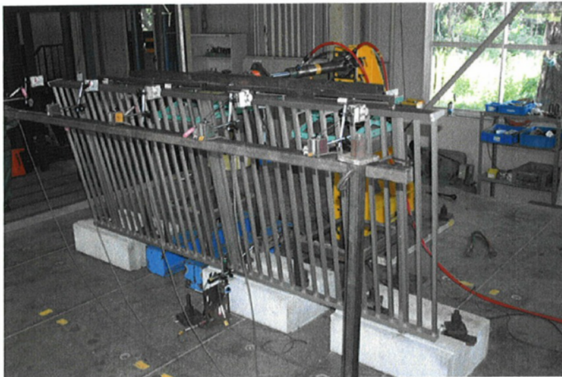
写真-4・1・2 破壊状況 ユニットの水平荷重試験 (ユニットの破壊状況)150型
