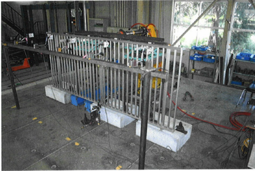
写真-4・1・1 試験実施状況 ユニットの水平荷重試験 (試験実施前)150型
